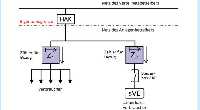
MK E5 Standardbezug mit nachgelagerter Messung für Steuerbare Verbrauchseinrichtung
