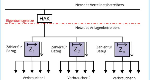
MK E3 Kombination Standardbezug und steuerbare Verbrauchseinrichtung nach §14 a EnWG (Modul 1)
