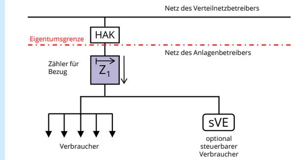
MK E4 Kombination Standardbezug und Steuerbare Verbrauchseinrichtung nach §14 a EnWG (Modul 2)
