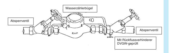
Die Wasserzähleranlage ist unmittelbar nach der Hauptabsperrvorrichtung im Gebäude bzw. im Wasserzählerschacht vorzusehen. Die Art, Lage und Größe des Wasserzählers bzw. Wasserzählerschachtes wird von der EVF festgelegt. Notwendige Abweichungen sind nur nach vorheriger Absprache mit der EVF möglich.
